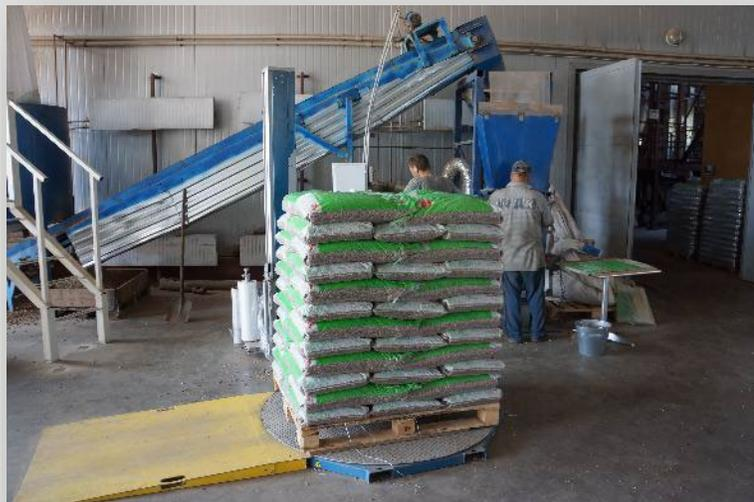
На сегодняшний день на заводе установлена **автоматическая линия фасовки в мешки по 15 кг**, производительностью: **3,5 тонны в час**.
